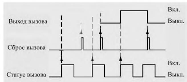
Вызов: выход вызова активен до тех пор, пока не будет сброшен вручную с помощью программы для ПК. Функция вызова активируется при активации сигнализации.
