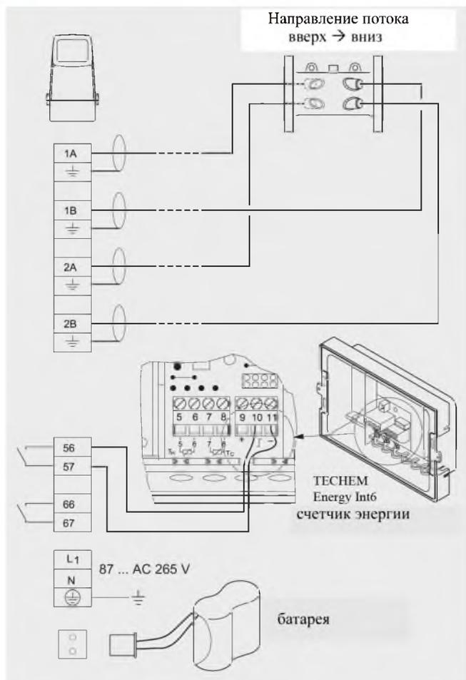
На схеме показано подключение кабеля преобразователя между клеммами передатчика и соответствующего преобразователя, и электрическое подключение тепловычислителя Techem Energy Int6.
