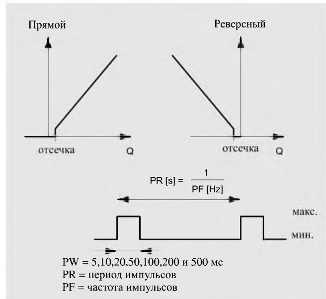
Вес импульса: выходы А/В конфигурируются как объем на один импульс, вычисляемый на прямом/реверсном или прямом/реверсном потоке нетто. Величина веса импульса свободно масштабируется (только для 475).
